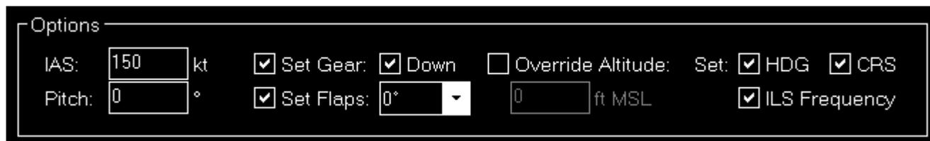
Hier finden Sie verschiedene Optionen wie Geschwindigkeit und Fahrwerk-/Klappenstatus, die verwendet werden, wenn Ihr Fluggerät platziert wird.
